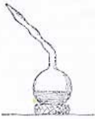
Figura 5.2 Cuello de matraz calentado y cerrado
