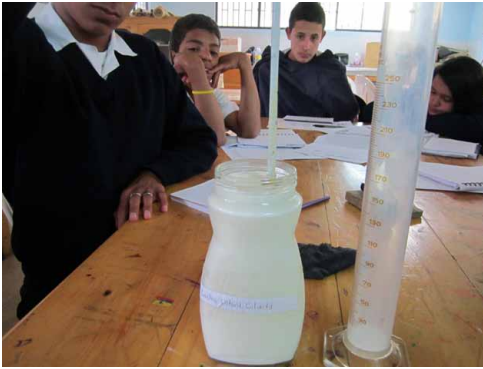
Figura 4.4 Aerómetro aplicado a una cantidad de leche
