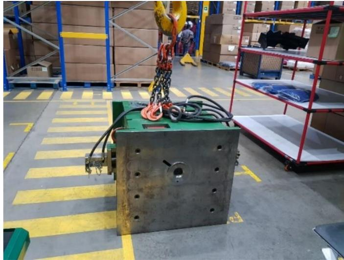
**Figura 13.** Molde de inyección de plástico.
