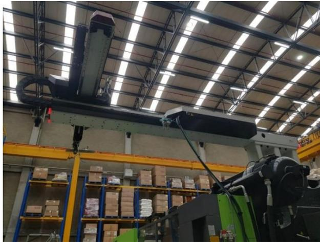
**Figura 7.** Robot de extracción de piezas inyectora 1100T.
