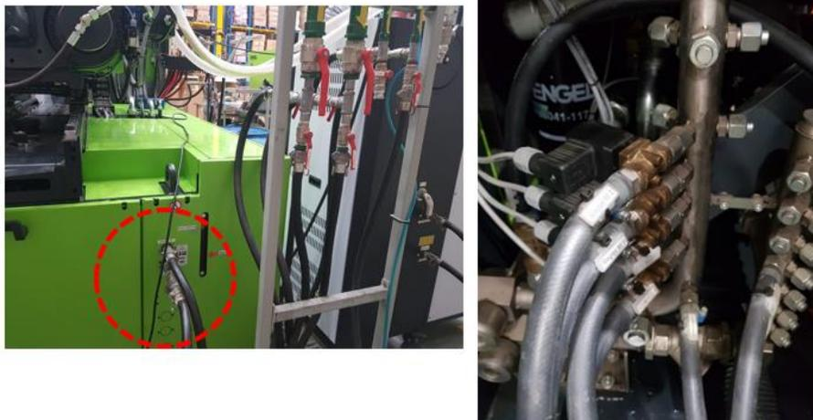
**Figura 8. a)** Entrada y salida distribuidor, **b)** Electroválvulas y distribuidor de agua fría.
