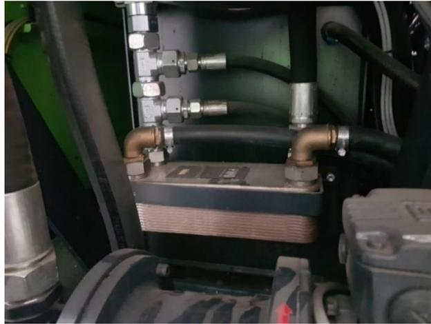
**Figura 9.** Intercambiador de aceite inyectora Engel.
