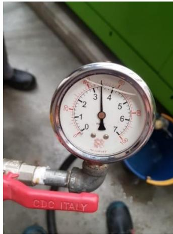
**Figura 18.** Presión del circuito de la red de agua de refrigeración.
