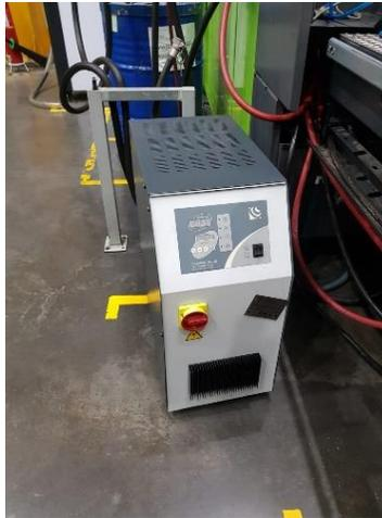
**Figura 5.** Atemperador inyectora 400T.
