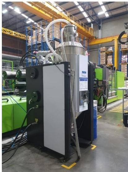
**Figura 6.** Deshumidificador inyectora 1100T.
