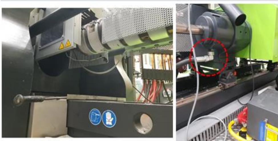
**Figura 10.** a) Unidad de inyección Engel, b) Travesa del tren de inyección.
