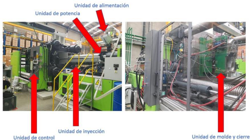
**Figura 4.** Componentes en inyectora de 1100 toneladas de inyección.
