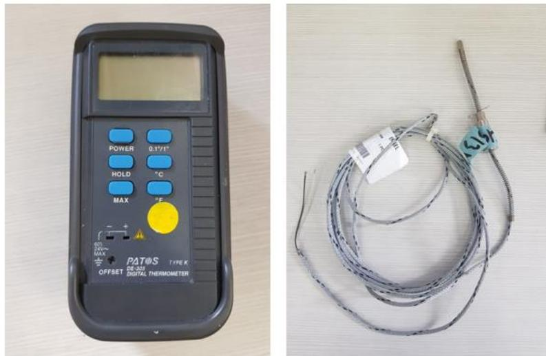
**Figura 14.** a) Termómetro digital DE-305, b) Termocupla tipo K.
