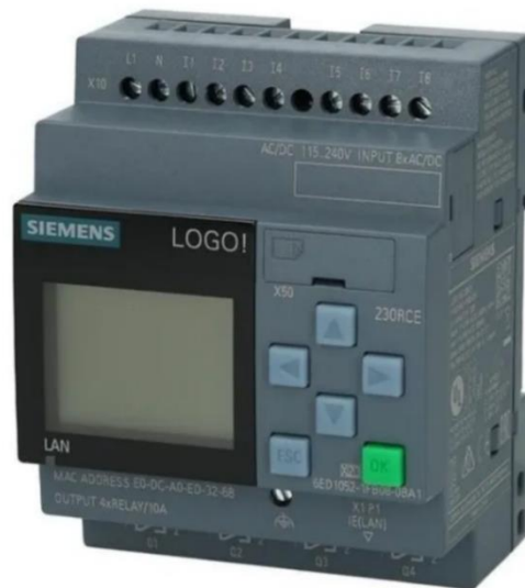
Ilustración 50. PLC elegido: LOGO!8. Fuente: Siemens.
