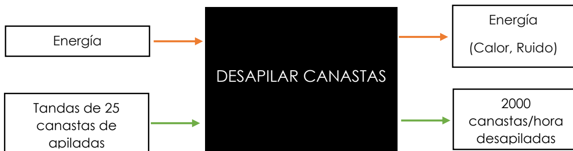
Ilustración 13. Análisis funcional de caja negra de la máquina para desapilación de canastas.
