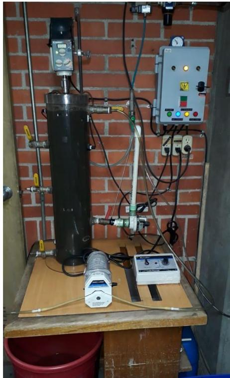
**Figura 4.4** Foto del sistema SBR instalado en el laboratorio del grupo GDCON (Fuente propia).
