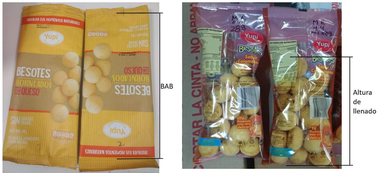
Figura 6. Dimensiones BAB y altura de llenado para calcular el porcentaje de llenado en el paquete.
