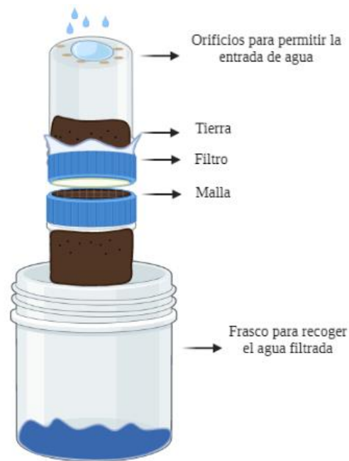
Fig. 21. Esquema del montaje para cuantificación de cobre de la tierra proveniente de Apartadó
