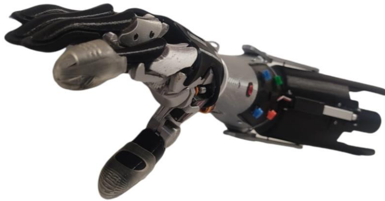
Figura 38: ensamble completo del dispositivo de asistencia – Vista superior
