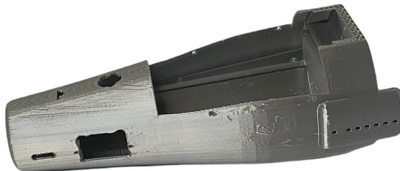
Figura 32: pieza del antebrazo después de impresión 3D
