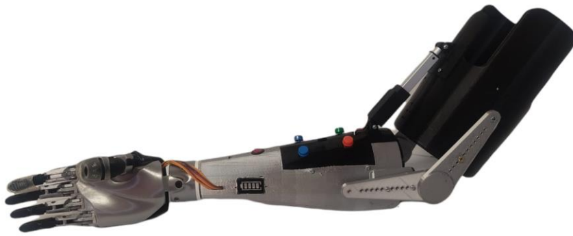
Figura 37: ensamble completo del dispositivo de asistencia – Vista lateral
