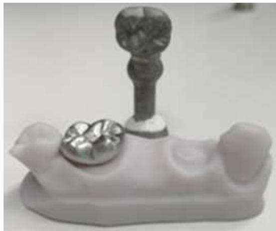
El análisis que se realiza a las coronas impresas, y en general a todas las piezas, con el colado metálico es la adaptación final de la pieza sobre el troquel o modelo sobre el cual fueron diseñados y la calidad de detalles copiados durante el proceso. En la **Figura 13** se muestra los resultados obtenidos para el desarrollo de New Stetic, en los anexos (**Anexo 7** y **Anexo 8**) se muestra los resultados de las otras dos resinas analizadas.
