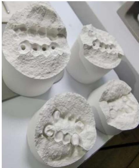
Como se observa en la **Figura 16**, los revestimientos se notan completamente limpios, no hay evidencia de presencia de resina sin calcinar o cenizas producto de calcinación, lo que indica el cumplimiento de uno de los requisitos de la resina.
