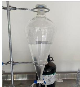
**Fig. 2.** Muestras patrón con solvente *n*-hexano
