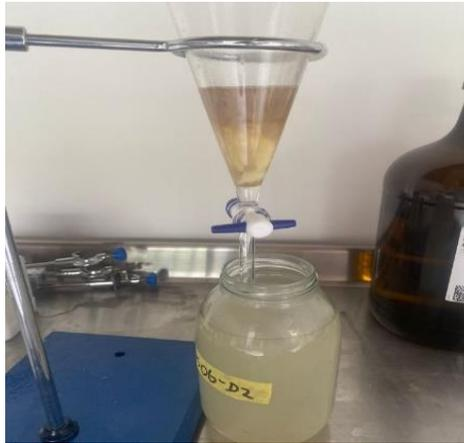
**Fig. 4.** Muestra en embudo de separación fase orgánica y acuosa.
