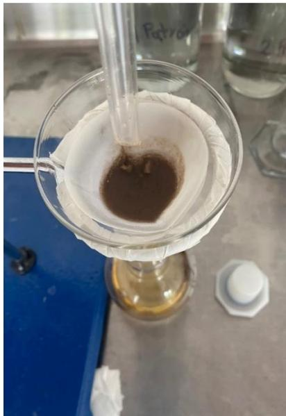
**Fig. 5.** Filtro separador con sulfato de sodio ( $\text{Na}_2\text{SO}_4$ )
