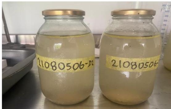
**Fig. 1.** Muestras adicionadas con aceite de cocina y preservadas con ácido sulfúrico
