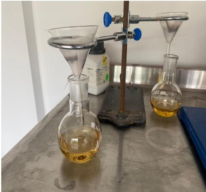
**Fig. 6.** Muestra filtrada en balón de destilación
