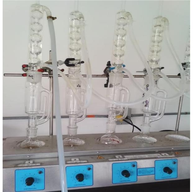
**Fig. 7.** Equipo para recuperación de solvente
