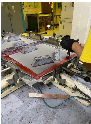
Fig 18. Proceso de pegado de una pantalla serigráfica
