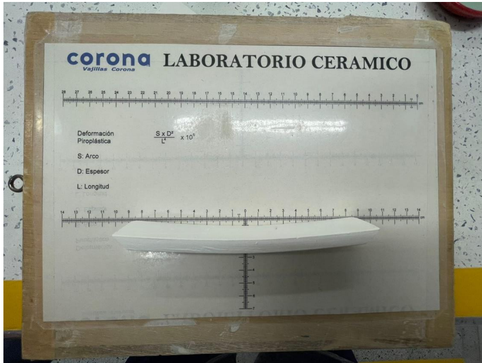
Fig 11. Medición de la deformación pirolástica de una barra
