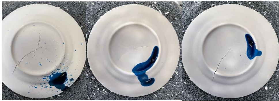
Fig. 25. Platos de loza de ensayo con grieta
