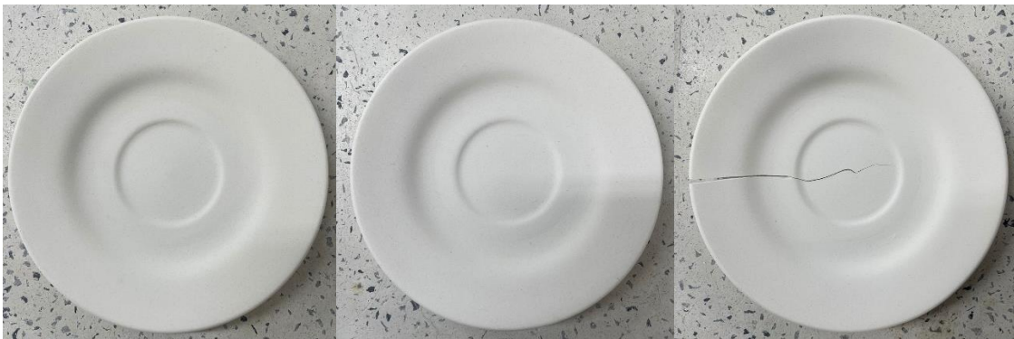
Fig. 26. Platos de loza quemados comparativo, ensayo y rotura
