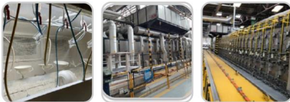
Fig 13. Esmaltado, primera coccion y segunda coccion
