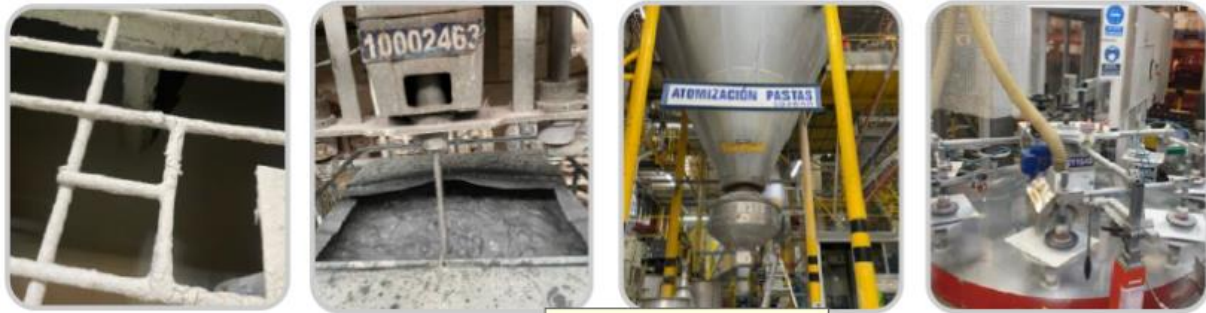
Fig 12. Dispersion, adición de ligantes, atomización y prensado
