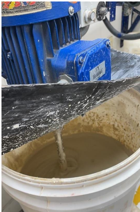
Fig 7. Agitador para dispersar y homogenizar pasta
