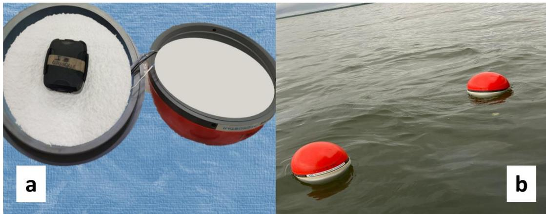
**Figura 2.** Derivadores superficiales de la UdeA a) Dispositivo electrónico de ubicación satelital y b) Derivadores ubicados en el agua.
