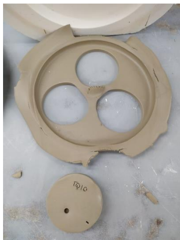
Fig 3. Rodaja para medición de espesor y dureza.
