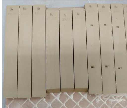
Fig 5. Probetas para pruebas físico-cerámicas (de izquierda a derecha, resistencia, deformación y contracción).
