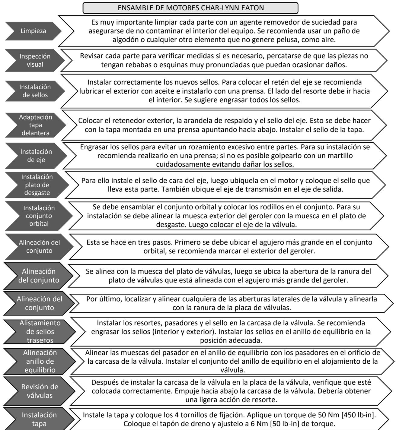
Figura 50. Ensamble de motores tipo orbital Char-Lynn Eaton
