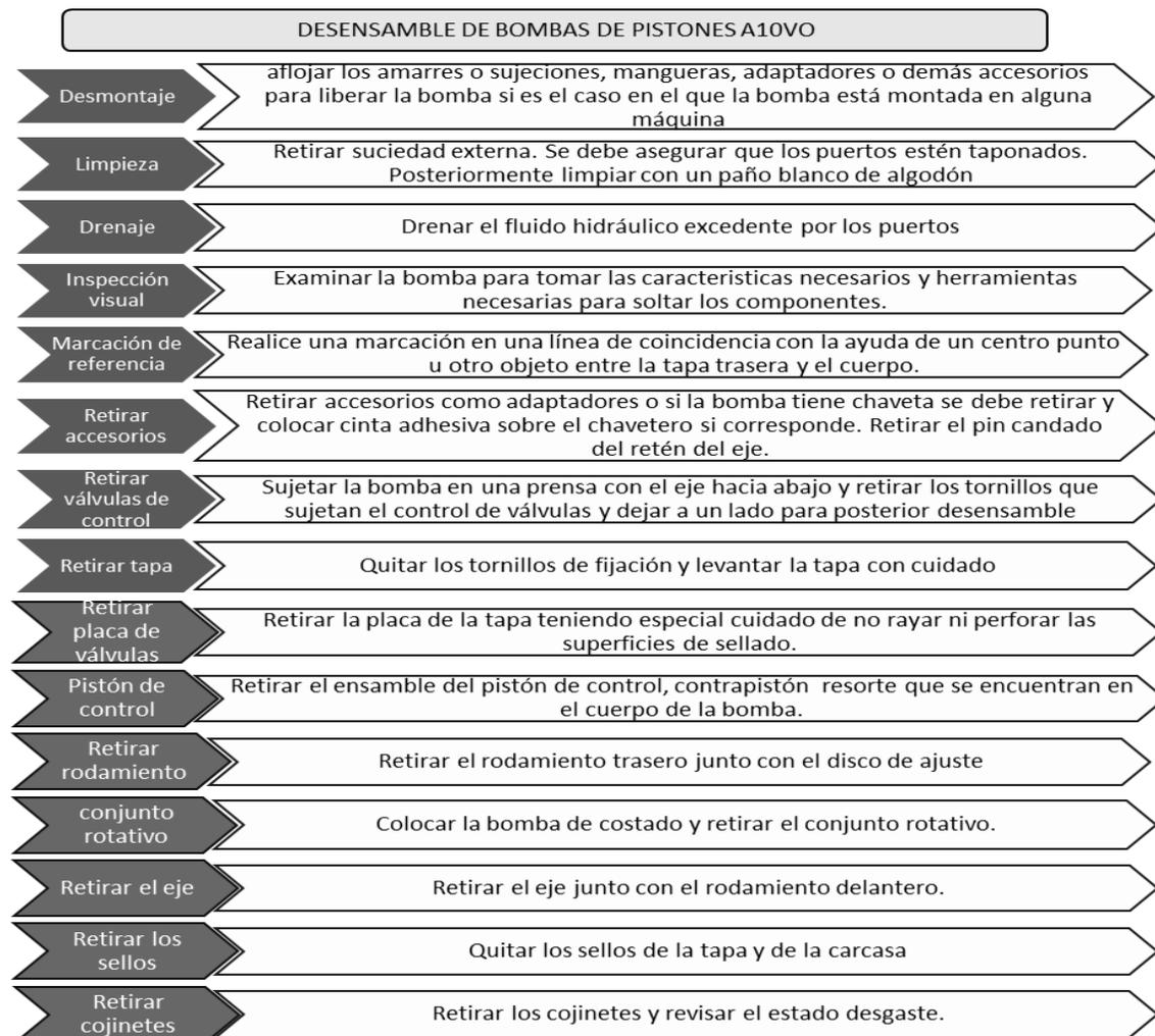
Figura 40. Desensamble de las bombas de pistones Rexroth A10VO series 31.
