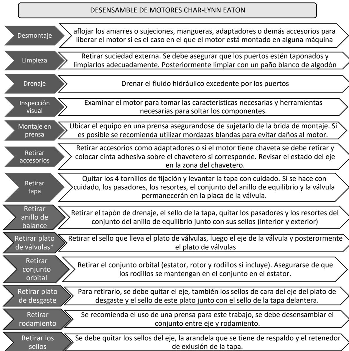
Figura 49. Desensamblaje de motores tipo orbital Char-Lynn Eaton
