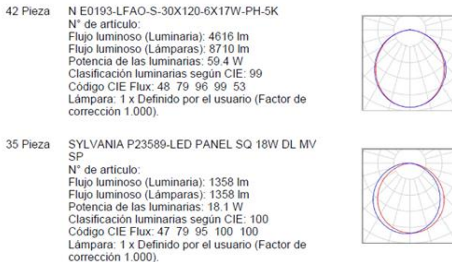
Fig. 6. Especificaciones de luminarias seleccionadas.
