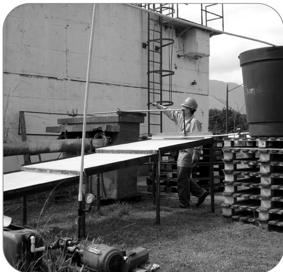
Reactor solar para tratamiento fotocatalítico de aguas residuales en funcionamiento
