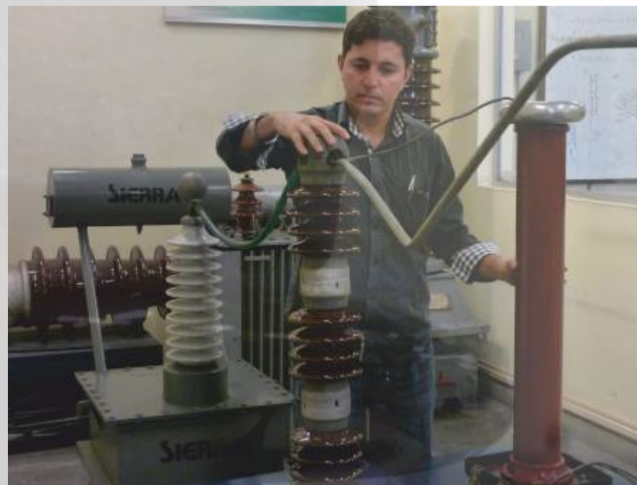
El docente Edwin García Quintero realizando el montaje para la prueba de flameo en seco de aisladores
