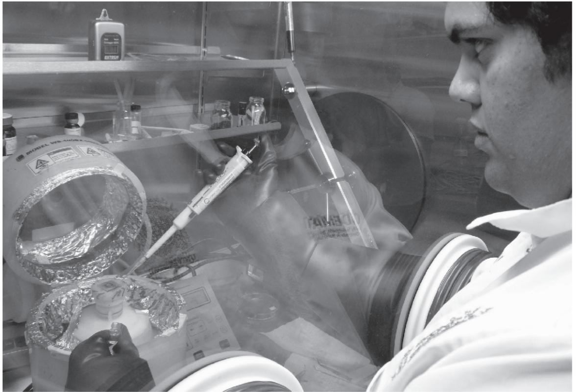
Trabajo en la cámara seca (DRY BOX) donde la atmósfera interior es controlada. En este equipo el polvo y la suciedad son mínimos, no hay aire, solo nitrógeno; y la humedad es muy reducida. "La nanotecnología exige cuartos más limpios que una sala para una operación a corazón abierto", explica el ingeniero Franklin Jaramillo.
