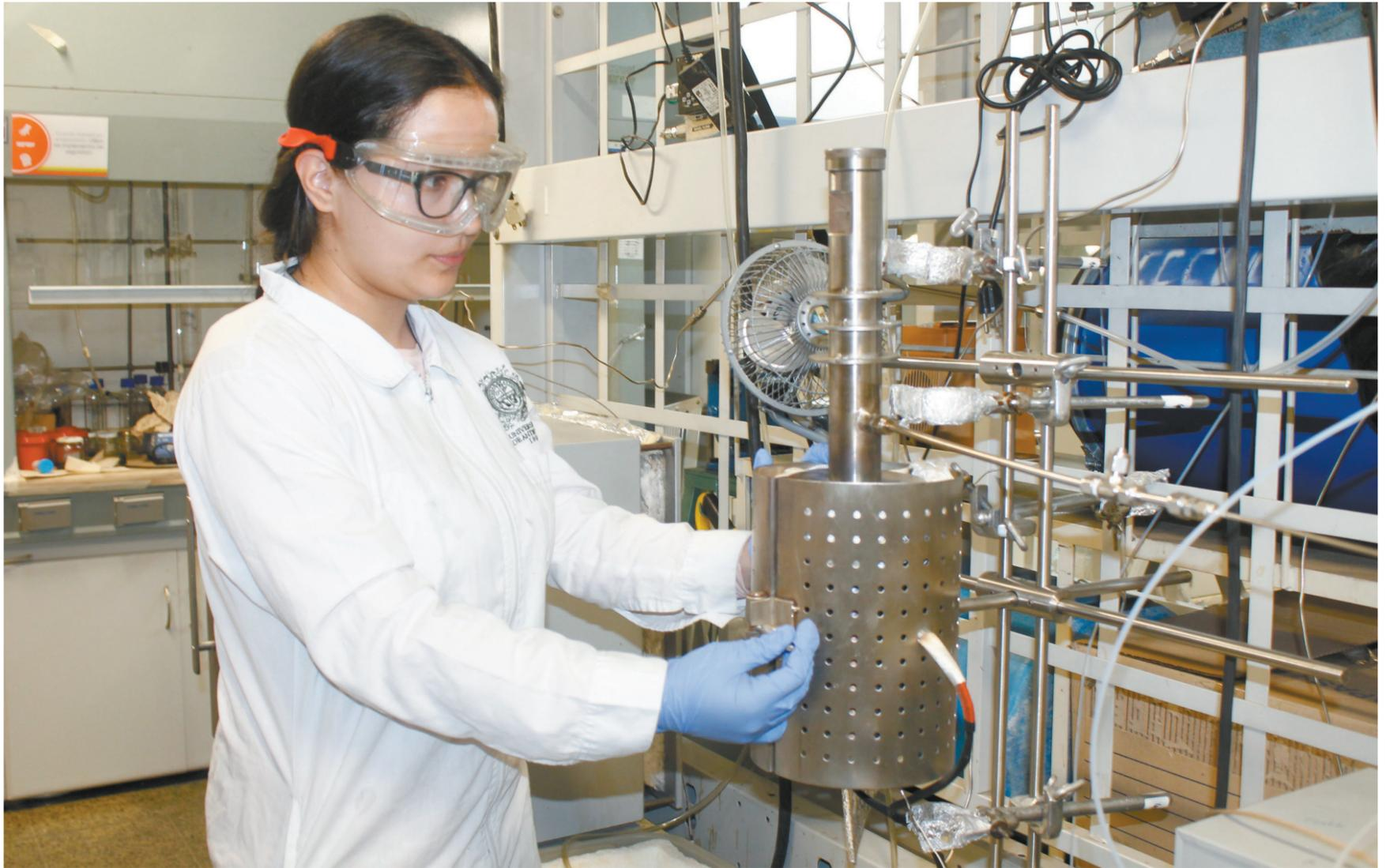
Montaje del reactor para el proceso de gasificación a escala de laboratorio.
