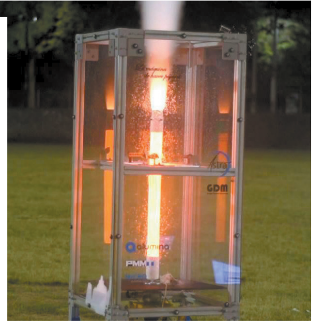
Prueba estática del motor cohete "Cacique Candela". Este motor propulsará un cohete a una altura de 2 km aproximadamente y será una de las actividades del semillero del 2018. Este vuelo se hará en alianza con la Fuerza Aérea Colombiana.
