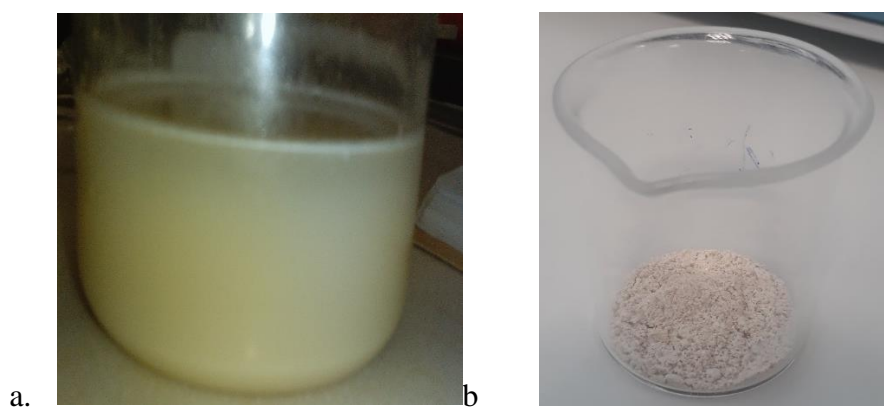
Figura 17. Emulsión de alimentación antes de ingresar al secador por atomización extracto: agentes encapsulantes (a) y producto seco (b)
