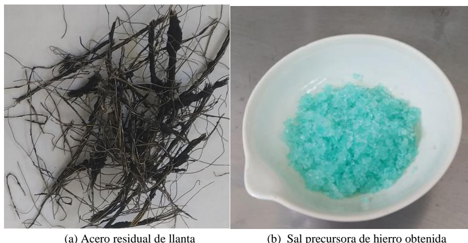
Figura 2-7. (a) Acero residual de llanta, (b) Sal de hierro obtenida del acero residual de llanta.
