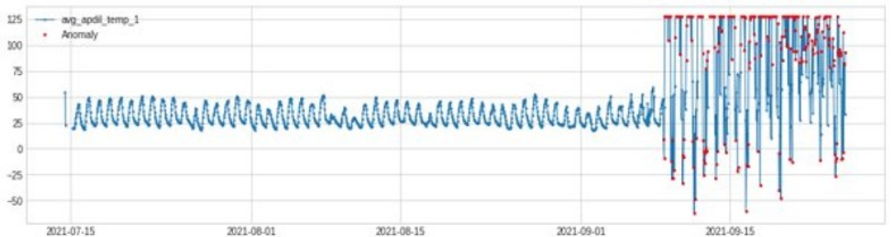
Figura 12: MÉTODO ThresholdAD, compara cada valor de serie de tiempo con umbrales dados.
