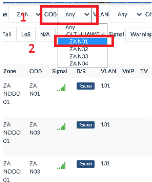
Figura 5. Pantallazo del Smart OLT que muestra cómo identificar un nodo y sus cajas.
