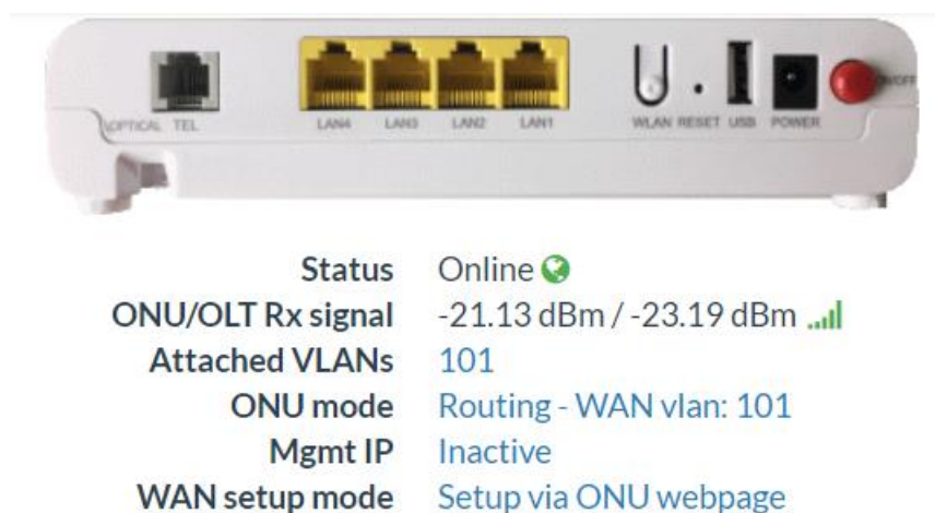
Figura 1. Esquema de conectores de una ONU. Tomado de https://velonet.smartolt.com/
