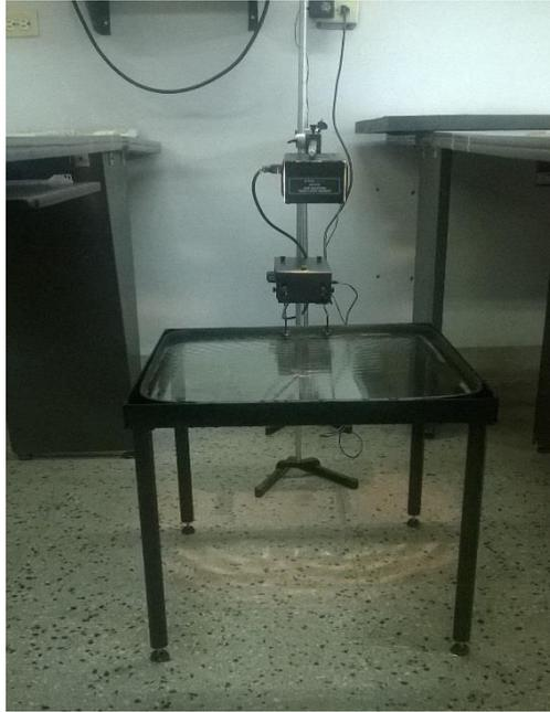
*Figura 23. Cubeta generadora de ondas del instituto de Física de la Universidad de Antioquia empleada para tomar la fotografía del patrón de interferencia que será insertada en el programa GeoGebra.*
