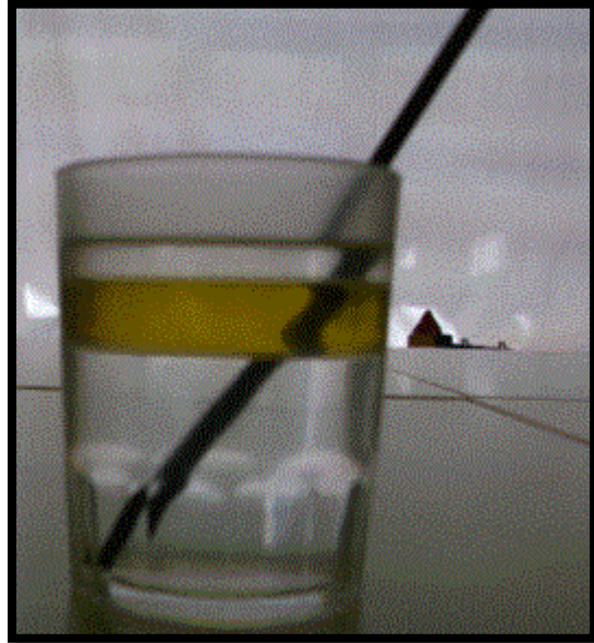
Figura 7: Refracción de la luz en aire-aceite-agua.
