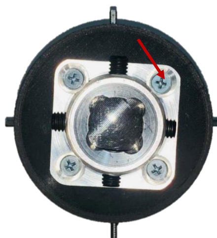
Figura 64. Ensamble acoples piramidales. Se señala el tornillo para fijar el acople.
