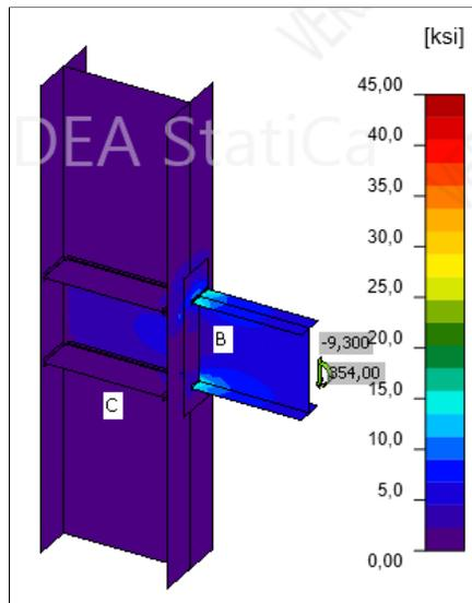
**Figura 7** Tensión resultante sobre la conexión
