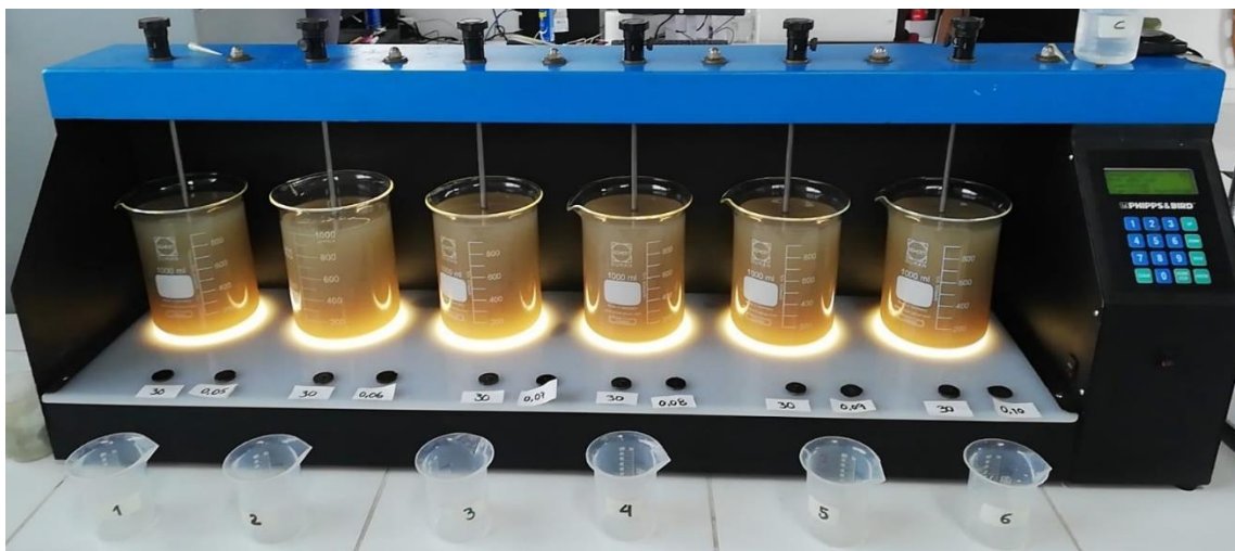
Ilustración 3. Montaje del ensayo de jarras con dosificación de coagulante y ayudante
