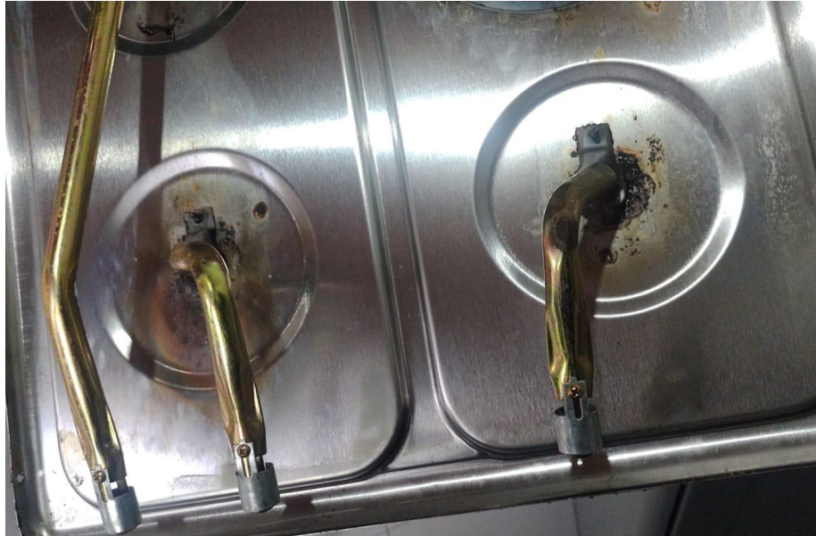
Figura 15 Tubos quemadores de cubierta.
