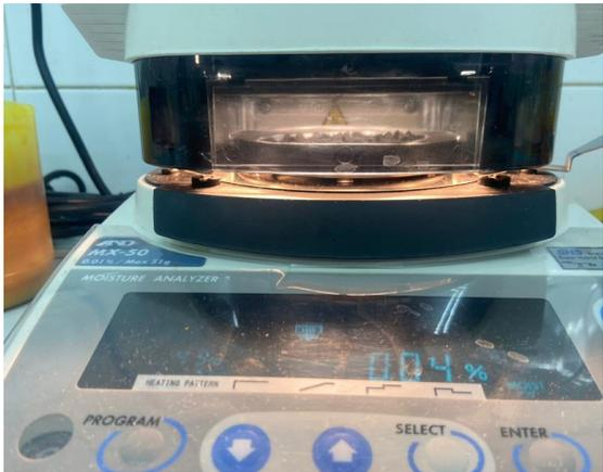
*Ilustración 15. determinación de humedad en calentador de halógeno.*
