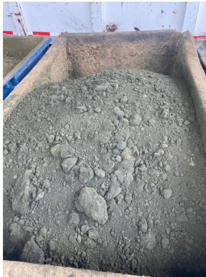
*Ilustración 3. tierra de blanqueo usada en contenedores de almacenamiento de residuos.*
