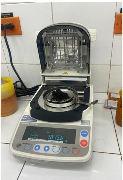
*Ilustración 14. pesaje de la muestra para determinación de humedad.*
