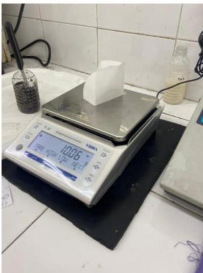
*Ilustración 10. pesaje de la muestra para extracción de aceite y determinación de acidez.*
