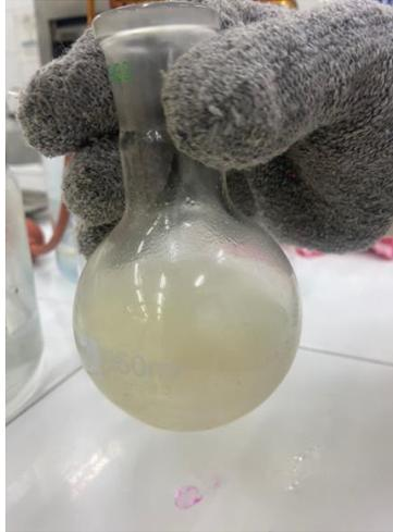
*Ilustración 13. muestra de aceite residual con solución de etanol.*
