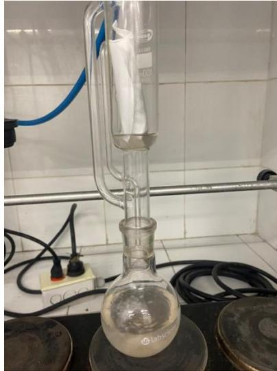
*Ilustración 11. montaje con extracción de equipo Soxhlet.*
