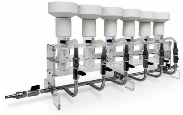
Figura 12. Sistema de filtración múltiple
