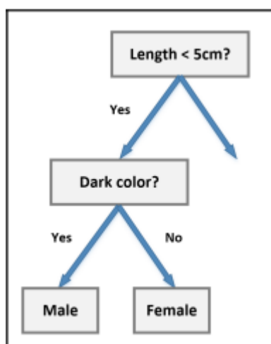
Figura 18. Ejemplo de un árbol de decisión básico para definir el género de una persona según el color y largo de su cabello [13].
