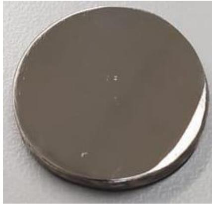
Fig. 19. Muestra para ensayo abrasivo, 5 mm x 25 mm.
