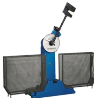
Fig. 15. Máquina tipo péndulo para ensayo de impacto
