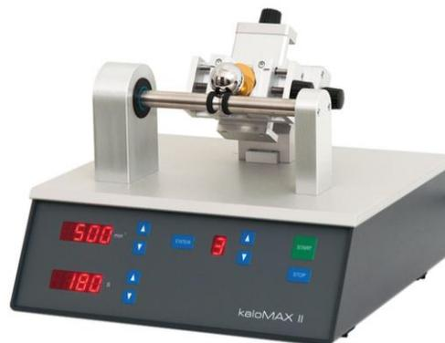
Fig. 18. Equipo para ensayo de desgaste abrasivo, método calotest.
