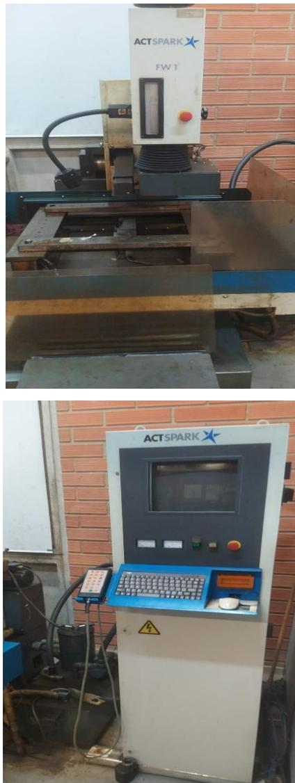
Fig. 13. Equipo de corte por hilo CNC ACT SPARK FW1.
