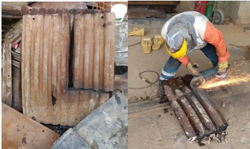
Fig. 8. Proceso de extracción de las muestras. a) Corte con equipo de oxiacetileno. b) Corte con pulidora
