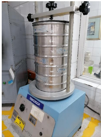
Fig. 8. Rotab utilizado para la caracterización granulométrica de las granillas.
