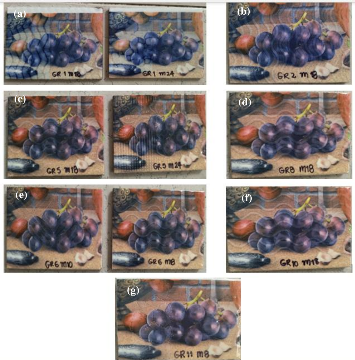
Fig. 22. Muestras que fueron rechazadas en el primer ensayo: (a) GR 1 malla de 18 y 24 hilos, (b) GR 2 malla de 18 hilos, (c) GR 5 malla de 18 y 24 hilos, (d) GR 8 malla de 18 hilos, (e) GR 6 malla de 10 y 8 hilos, (f) GR 10 malla de 18 hilos y (g) GR 11 malla de 8 hilos.
