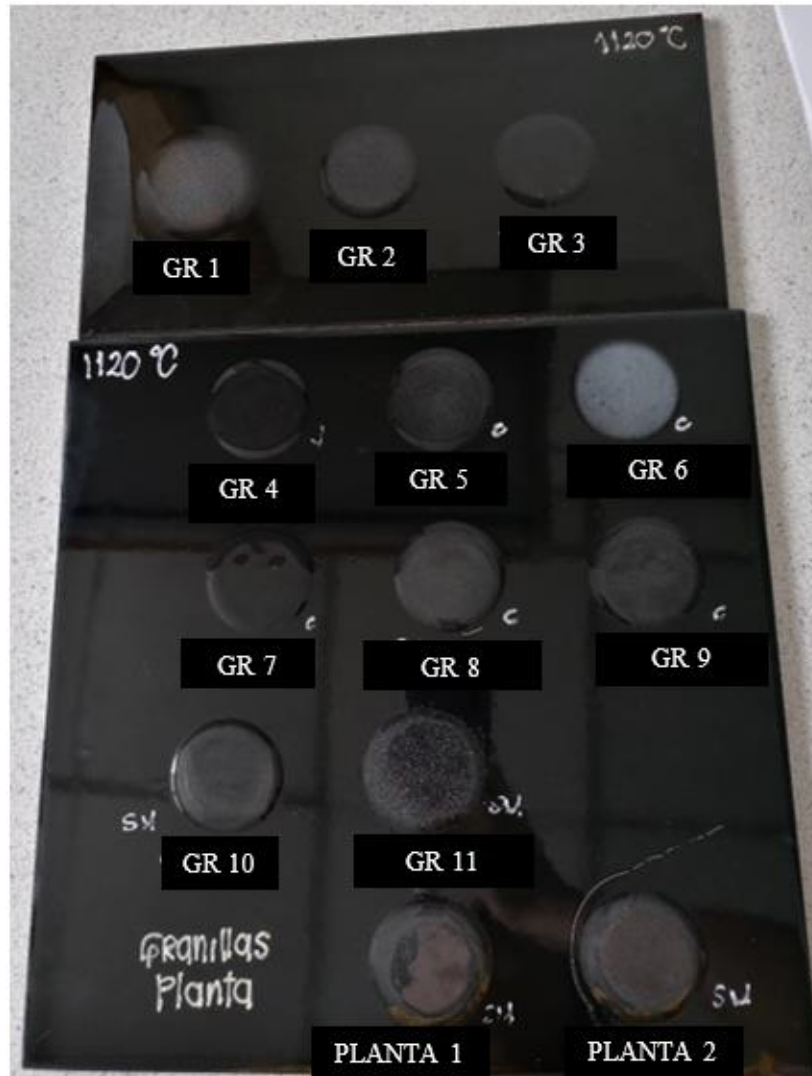
Fig. 15. Botones de las 13 granillas quemadas a temperatura de monococción 1120 °C en un ciclo alrededor de 48 min.
