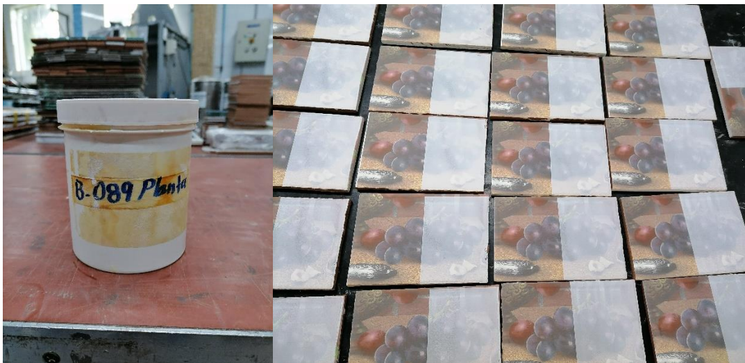
Fig. 10. Muestras decoradas con aplicación en la mitad de la base protectora de planta.
