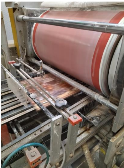
Fig. 11. Aplicación de capa protectora mediante rodillo.
