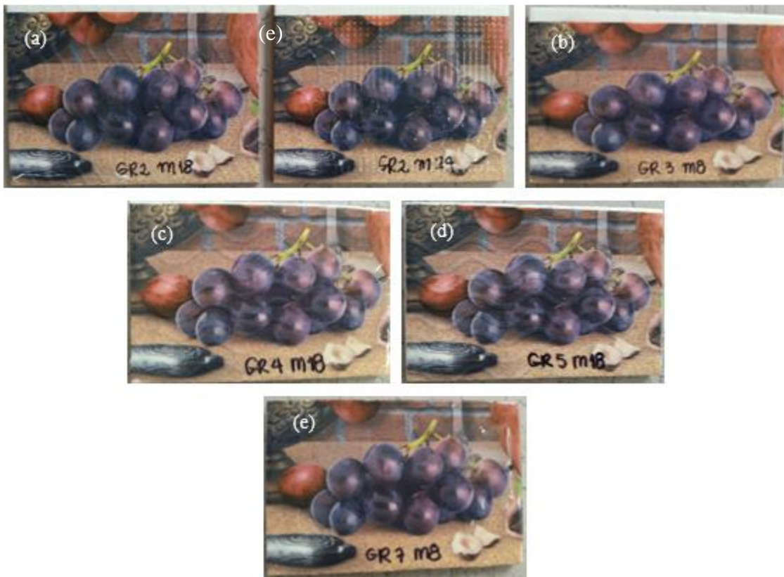
Fig. 26. Muestras que presentan buen comportamiento: (a) GR 2 malla de 18 y 24 hilos (b) GR 3 malla de 8 hilos, (c) GR 4 malla de 18 hilos, (d) GR 5 malla de 18 hilos y (e) GR 7 malla de 8 hilos.
