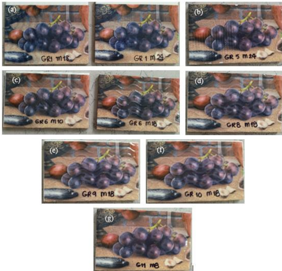
Fig. 25. Muestras que fueron rechazadas en el segundo ensayo: (a) GR 1 malla de 18 y 24 hilos, (b) GR 5 malla de 24 hilos, (c) GR 6 malla de 10 y 18 hilos, (d) GR 8 malla de 18 hilos, (e) GR 9 malla de 18 hilos, (f) GR 10 malla de 18 hilos y (g) GR 11 malla de 8 hilos.
