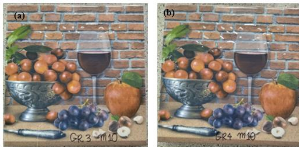
Fig. 29. Muestras que fueron aceptadas en el ensayo final utilizando una malla de 10 hilos: (a) GR 3 y (b) GR 4.
