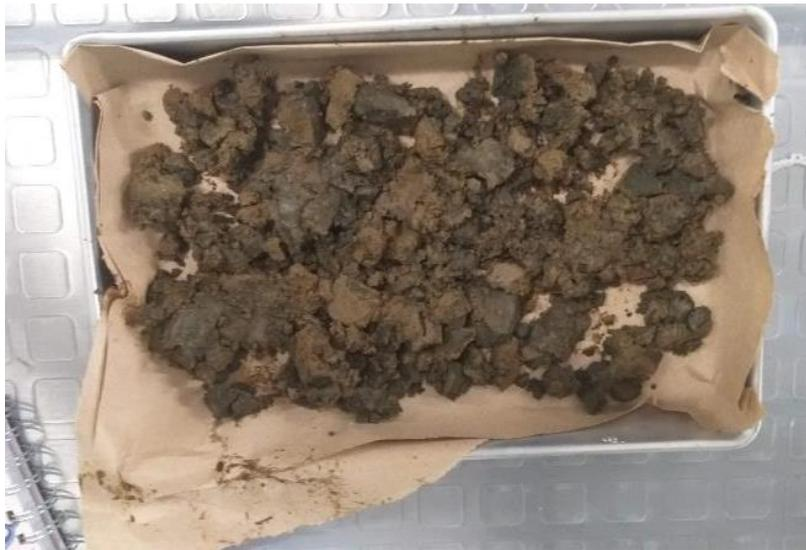
**Figura 9.** Lodo húmedo preparado para ser secado
