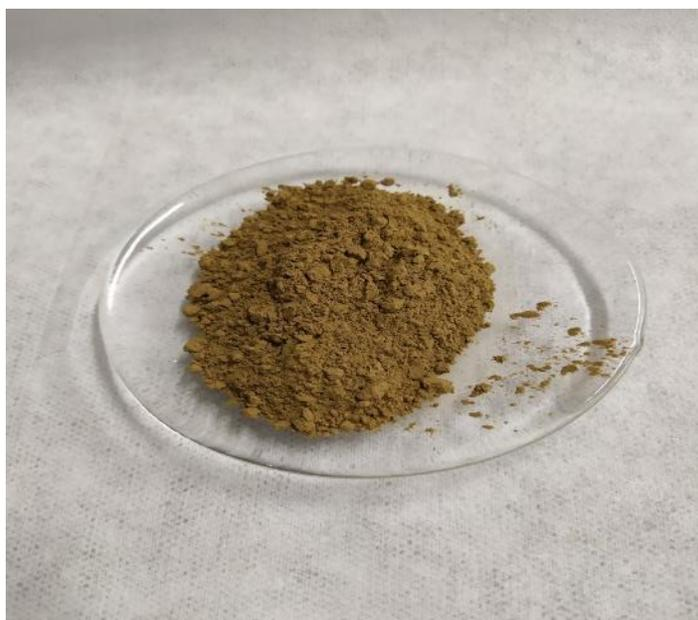
**Figura 10.** Lodo seco triturado y tamizado malla 16
