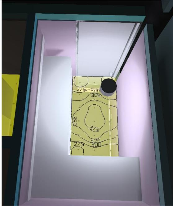
Fig. 20. Vista 3D de Cuarto de herramientas con curvas isolux.
