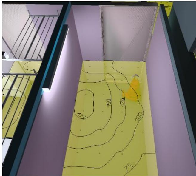
Fig. 8. Vista 3D de Cuarto Técnico de Bombas con curvas isolux.
