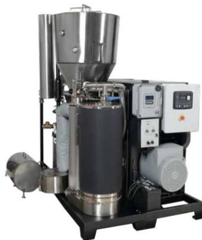
Fig.13. Sistema All Power Labs - Power Pallet PP30 (25 kW). Fuente imagen ((All Power Labs, 2021).
