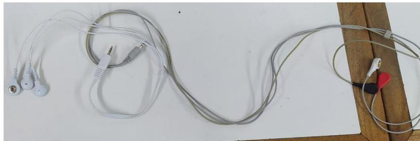
fig. 44 Cables usados para registrar con los electrodos Meditrace.
