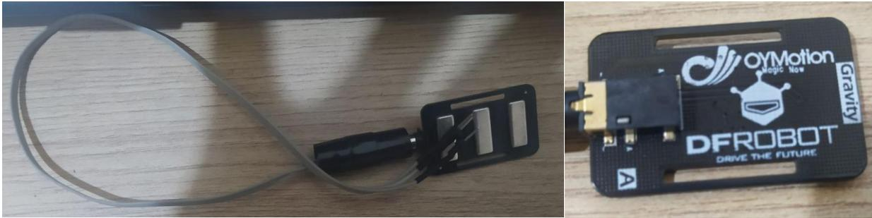
fig. 41 Electrodo secos soldados a una tarjeta OYMotion adaptado para usar en protoboard.
