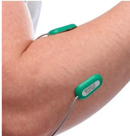
fig. 1 Sensor con electrodos secos sobre un brazo [25].
