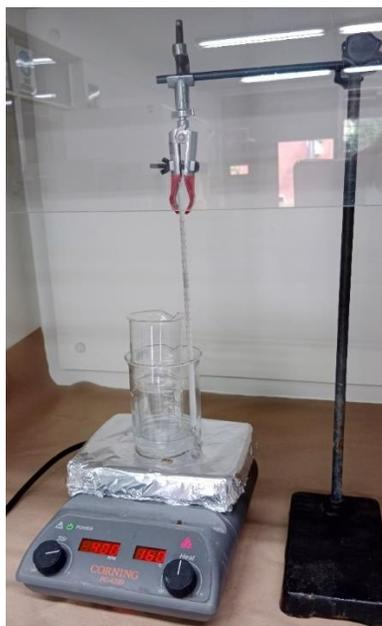
Fig. 8. Montaje preparación solución de PVA.
