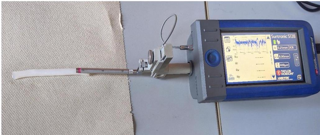
Fig. 14. Ensayo de rugosidad.
