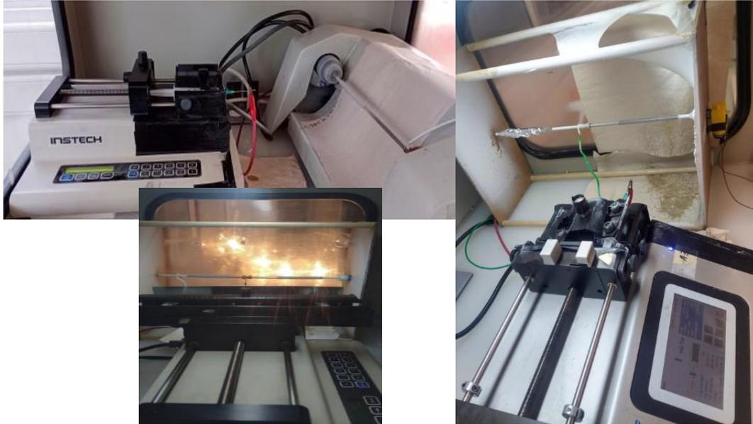
Fig. 17. Electrohilado en proceso.
