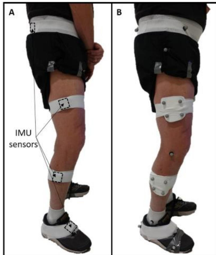
Fig. 1. Sistema compuesto por cuatro IMU para el análisis de marcha y la estimación de marcadores de envejecimiento y osteoartritis en la rodilla. Fuente [12].
