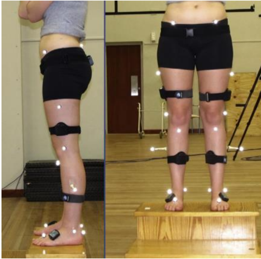
Fig. 2. Sistema compuesto por siete IMU, implementado para su validación como herramienta de análisis cinemático de la marcha, respecto a sistemas OMC. Fuente [8].
