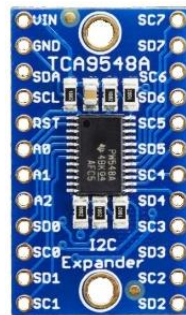
Fig. 19. Multiplexor TCA9548A de Adafruit con 1 canal de entrada y 8 canales de salida para comunicación bidireccional I2C. Fuente [27].
