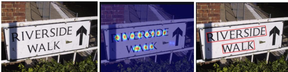
**Figura 6.** Visualización de la detección a nivel de carácter mediante CRAFT. 1. Imagen de entrada. 2. Mapas de calor predichos por nuestro marco propuesto. 3. Detección de resultados para textos de varias formas. Adaptado de (Baek et al., 2019).
