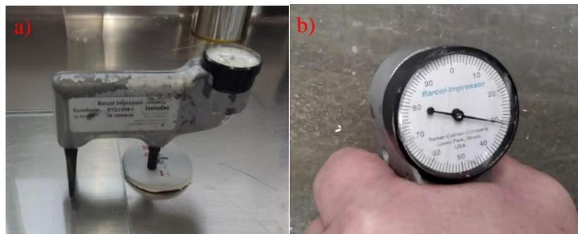
**Fig 13.** Ensayo de dureza Barcol en PRFV. **a)** Montaje y **b)** Resultados.
