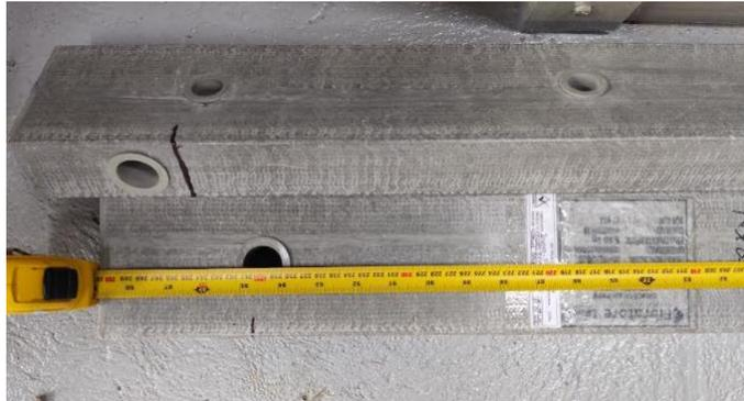
*Fig 6: Especificaciones metrológicas para crucetas de PRFV. a) Longitud.*
