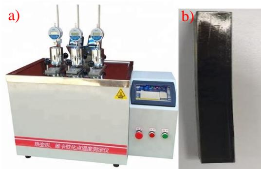
**Fig 20:** Resistencia a la deflexión térmica para resina de poliéster; **a)** Máquina para ensayo de HDT **b)** probetas para ensayo.
