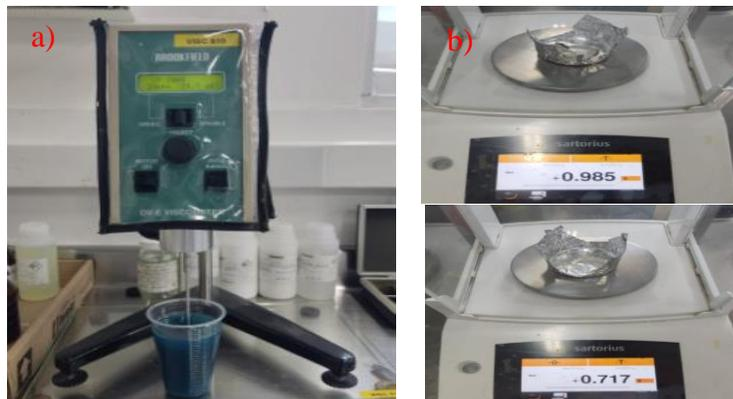
**Fig 24:** Caracterización de la resina de poliéster; **a)** Viscosidad y **b)** Porcentaje de sólidos.
