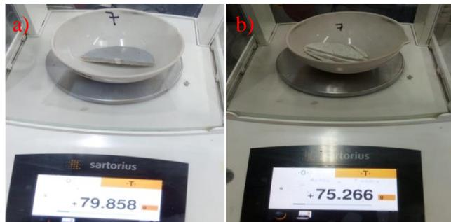
**Fig 15:** Determinación composicional de matriz y refuerzo en el material PRFV, **a)** Probeta y **b)** Probeta calcinada.
