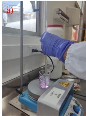
**Fig 26:** Caracterización de la resina de poliéster; **a)** Índice de acidez
