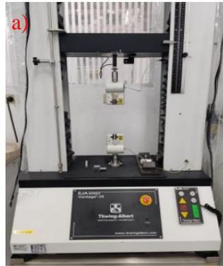
*Fig 11: Resistencia a la tracción para PRFV; a) Máquina universal*
