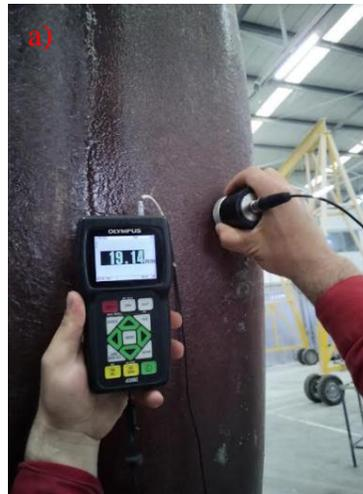
*Fig 4: Determinación de especificaciones para un tanque. a) Espesor.*
