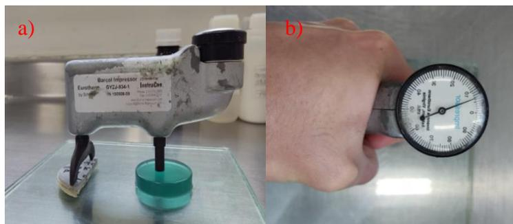
**Fig 21:** Dureza Barcol resina vinilester; **a)** Montaje y **b)** Resultados.
