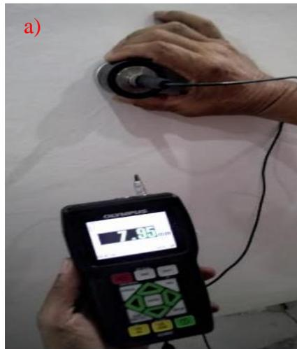
*Fig 1: Determinación de especificaciones para un poste. a) Espesor por ultrasonido.*
