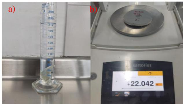
*Fig 9: Determinación de la densidad del material compuesto. a) Volumen desplazado y b) Masa.*
