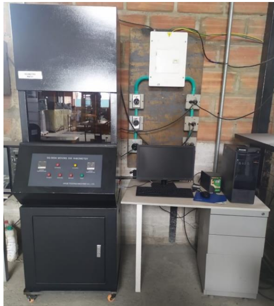
Fig. 13. Reómetro de vulcanización, MDR, del laboratorio de calidad de Darrow, Soluciones para tu moto [Elaboración propia].
