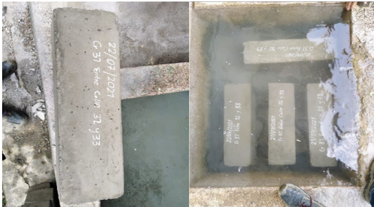
Fig. 17. Vigas elaboradas en obra de pavimentación Urrao, Antioquia
