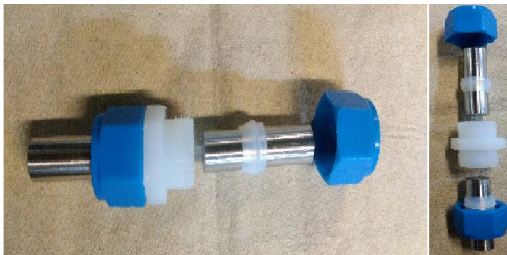
Figura 10. Celda Swagelok de dos electrodos empleada en los ensayos electroquímicos EIS.
