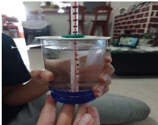
Figura 3: Calorímetro casero construido por uno de los estudiantes
