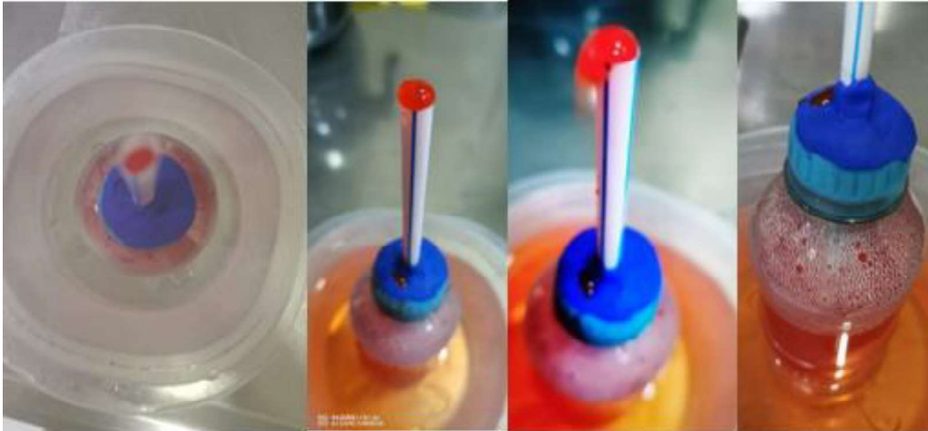
Figura 1: Termómetro construido por un estudiante, el cual muestra el funcionamiento del termómetro casero cuando es puesto en contacto con agua caliente.
