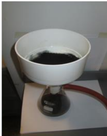
b) Separación de la fracción malténica y asfáltica por filtración al vacío
