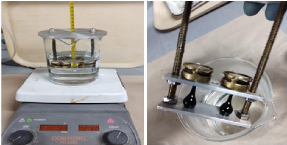
a) Montaje aparato bola y anillo
