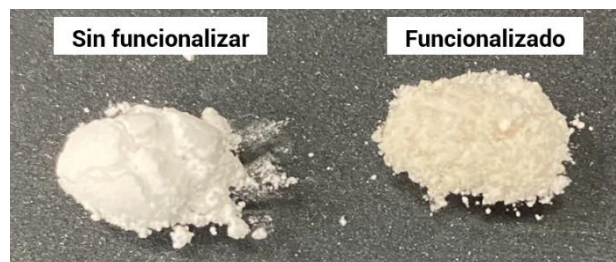
Figura 8. TiO 2 nps antes y después de la modificación superficial realizada a 130 °C por 2 horas con una relación de TFA/TiO 2 =6, a. en gel, b. en polvo.
