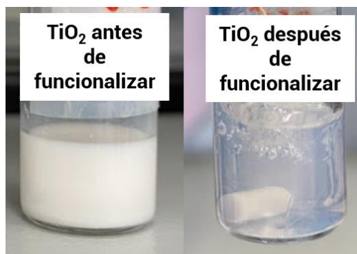
Figura 8. TiO 2 nps antes y después de la modificación superficial realizada a 130 °C por 2 horas con una relación de TFA/TiO 2 =6, a. en gel, b. en polvo.
