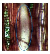
*Nota*. Fuente: https://n9.cl/63a85 (Salinas, 2018). Miembro del vaso observa punteaduras intervasculares alternas en lente.
