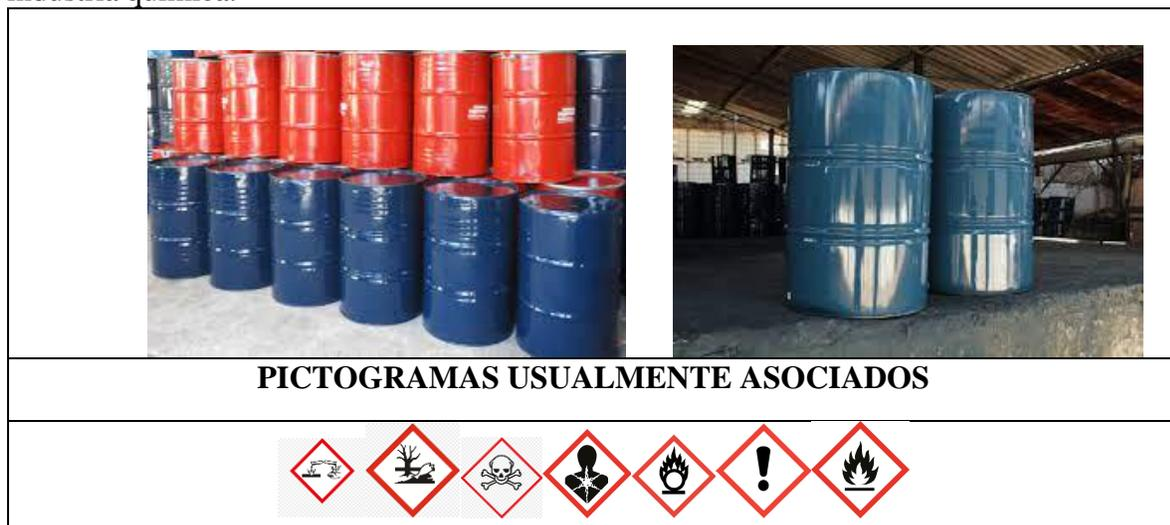
Este tipo de recipiente tiene dos vías de acceso en la tapa, la boquilla por donde se extrae el material y la boquilla de respiración que sirve para evitar que el recipiente implosione cuando se extrae el líquido.
